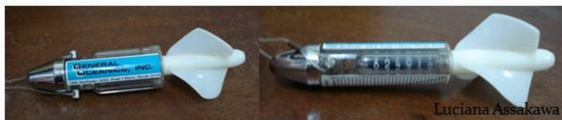
3 – Fluxômetro utilizado para obtenção dos dados do volume de água.
