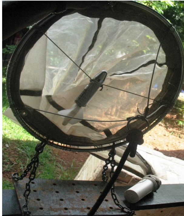
Figura 4 – Rede de ictioplâncton equipada com deflator metálico e fluxômetro.
